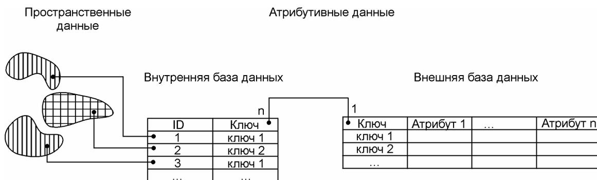
Рис. 36. Геореляционный способ связи пространственных и атрибутивных данных.
